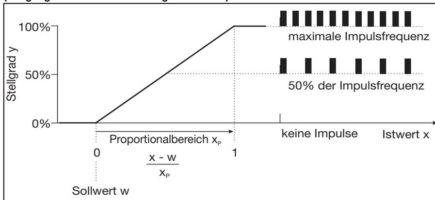
Überschreitet der Istwert  $x$  den Sollwert  $w$ , regelt der P-Regler proportional zur Regelabweichung. Beim Überschreiten des Proportionalbereiches arbeitet der Regler mit einem Stellgrad von 100 % (maximale Schaltfrequenz).
